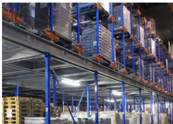
Kolejnice pro Shuttle montované na běžné nosníky paletového regálu.
