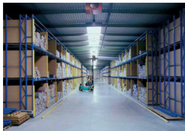
Regály pro horizontální skladování koberců, vybavené po stranách panely a ochranami.
