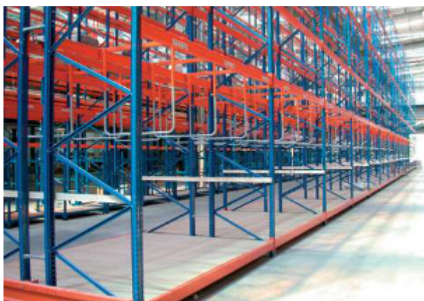
Speciální příslušenství umožňující vertikální skladování zboží. Dělitka jsou nastavitelná do výšky i do šířky.
