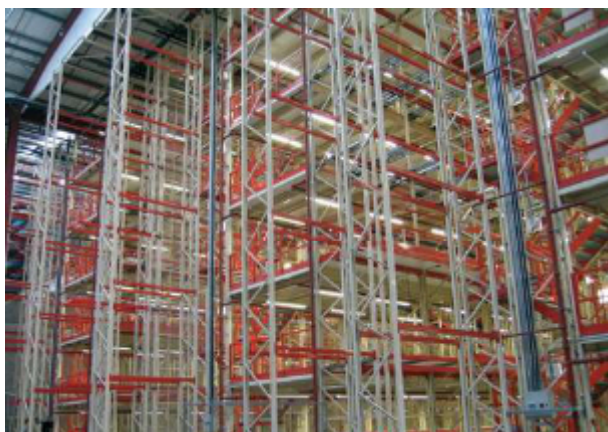
Vícepodlažní paletový regálový systém kombinovaný s Mezza- stow podlažním systémem.
